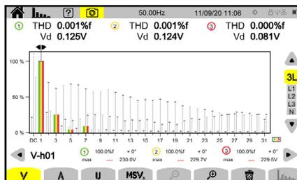
El modo Armónico
