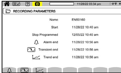
El modo Vigilancia sirve para verificar la conformidad de la tensión durante un plazo determinado. Utilice el software de aplicación para configurar el modo Vigilancia.
