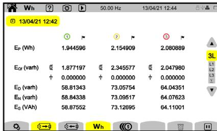
El modo Energía se utiliza para medir la energía consumida y generada a lo largo de un periodo y para indicar el precio correspondiente.
