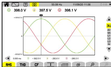
El modo Forma de Onda muestra curvas de tensión y corriente y valores calculados a partir de la tensión y la corriente, con excepción de armónicos, potencias y energías.
