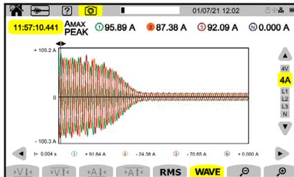
El modo Corriente Inrush sirve para capturar y registrar corrientes inrush (de irrupción) durante un tiempo determinado por la configuración seleccionada.
