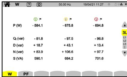
El modo Potencia muestra las mediciones de potencia (**W**) y los cálculos de factor de potencia (**PF**).
