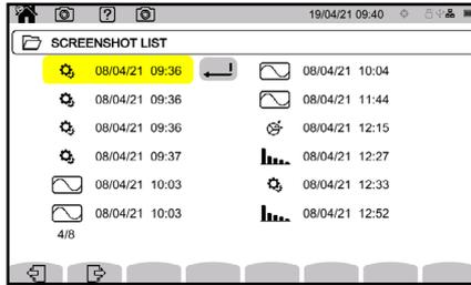
Las fotografías de pantalla se almacenan en la tarjeta SD en el directorio 8345\ Photograph. Se pueden descargar las fotografías a la computadora mediante el software de aplicación o mediante un lector de tarjeta SD (no incluido).
