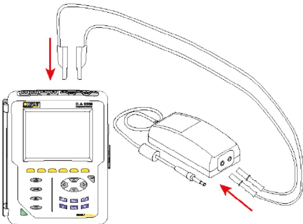
Dans l'exemple ci-dessus, l'adaptateur est branché entre le neutre (N) et la phase (L1).
