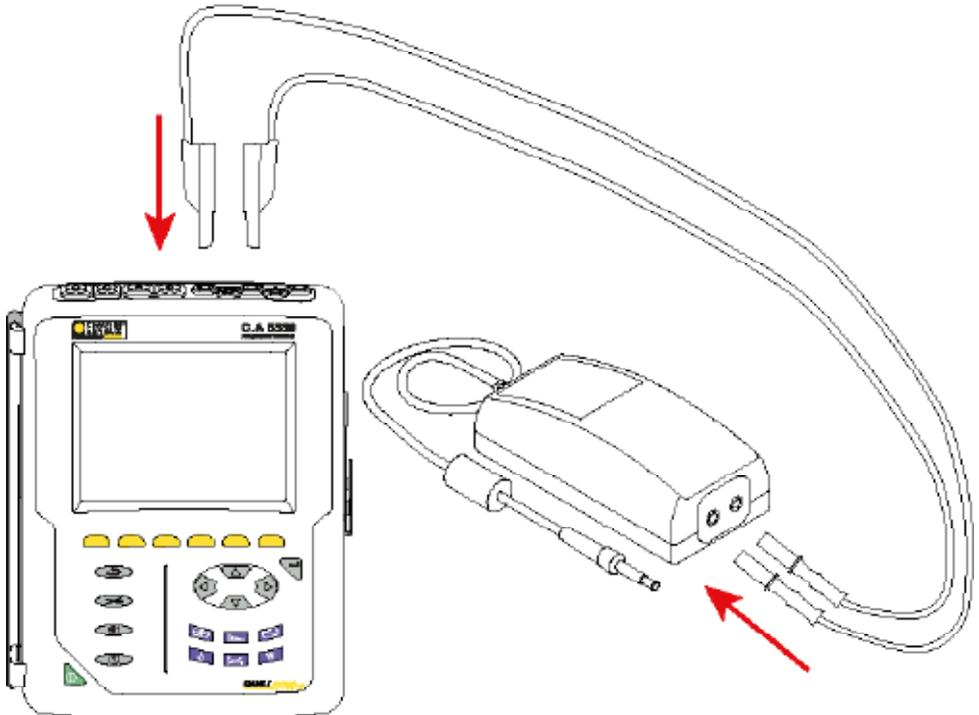
Im Beispiel oben ist das Netzteil zwischen Neutraleiter (N) und Phase (L1) angeschlossen.
