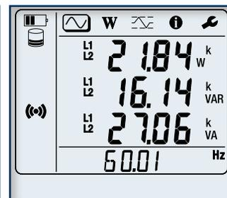
Les mises à jour en temps réel sont affichées pour la tension (V), le courant (A) la puissance active (P), la puissance réactive (Q), la puissance apparente (S), la fréquence (Hz), le facteur de puissance (FP).
