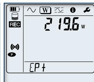
Énergie active (Wh), énergie réactive (var.h), énergie apparente (VAh). Les énergies affichées sont les énergies totales, de la source ou de la charge. (Le symbole « h » n'est pas affiché à l'écran. Vous verrez W, VA, var pour Wh, VAh et var.h. Les enregistrements téléchargés afficheront le « h ».)
