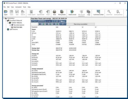
Afficher les paramètres de puissance et d'énergie – instantanés et totaux.
