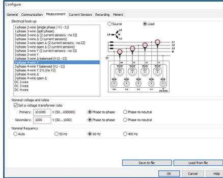
L'onglet Mesures spécifie le système de distribution électrique, les rapports de tension, la fréquence nominale et les options et rapports de sonde de courant.
