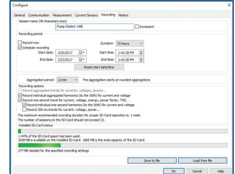
Dans l'onglet Enregistrement, configurez l'instrument pour mesurer (et enregistrer) sur une période d'enregistrement sélectionnable par l'utilisateur. Sélectionnez les intervalles de demande et affichez la mémoire disponible pour le stockage des données.
