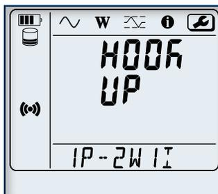
Le raccordement, le Wi-Fi et la période d'agrégation peuvent être configurés à partir du panneau avant du PEL 52. Les rapports de courant et le nombre de tours doivent être configurés au moyen du logiciel PEL Transer en fonction du type de capteur de courant.
