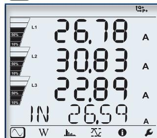
Les mises à jour en temps réel sont affichées pour la tension, le courant, la puissance, la fréquence, le facteur de puissance et la tangente
