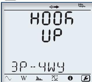
Les rapports de raccordement, de tension et de courant et la période d'agrégation peuvent être configurés à partir du panneau avant du modèle PEL 103
