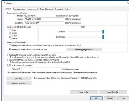
Les informations de base concernant la mise hors tension automatique, le nom et l'emplacement de l'instrument, le contraste et la luminosité de l'écran (modèles PEL 103 et PEL 105), le réglage de l'horloge en temps réel et le formatage de la carte SD sont faciles à réaliser à partir de l'onglet Général.
