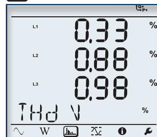
La distorsion harmonique totale (DHT) peut être affichée par phase ou la DHT du courant neutre de phase à phase peut également être affichée
