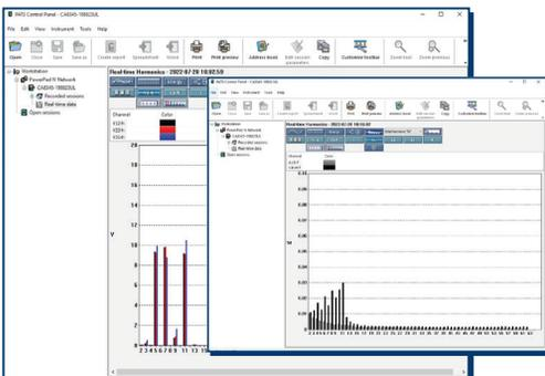
Afficher toutes les harmoniques du 1<sup>er</sup> au 63<sup>e</sup> ou les harmoniques du 1<sup>er</sup> au 62<sup>e</sup> sous forme de schéma à barres pour la tension, le courant et la puissance.
