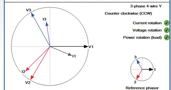
Schémas de l'écran du phaseur mis à jour : Affiche maintenant les schémas réels et de référence et indique si les orientations de tension, de courant et/ou de puissance correspondent à ce qui est prévu
