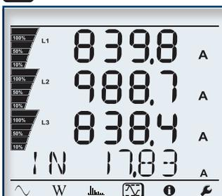
Valeurs maximales pour la tension, le courant (y compris le courant neutre), la puissance et les harmoniques
