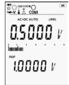
Modo REL Muestra valores relativos con respecto al valor medido de la referencia
