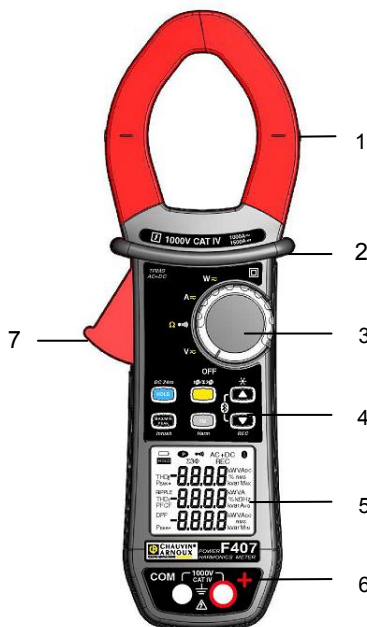
Figure 1 : la pince multimètre F407
