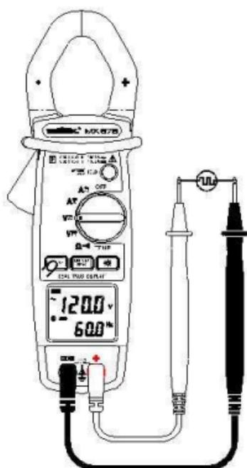
Posicionar el conmutador en  $V_{\tilde{}}$  y pulsar la tecla **DISPLAY**.
