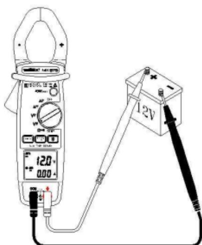
Schließen Sie die rote Messleitung an die Eingangsbuchse "+" und die schwarze Messleitung an die Eingangsbuchse "COM" an.
