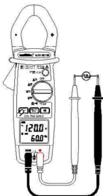
Stellen Sie den Wahlschalter auf  $V_{\tilde{A}}$  und drücken Sie die Taste **DISPLAY**.
