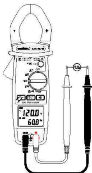
Posizionare il commutatore su  $V_{\tilde{A}C}$ , e premere sul tasto **DISPLAY**.
