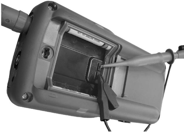
Conecte la sonda que se vaya a ajustar a la salida de la calibración situada detrás de este compartimento, como se indica en la figura de la izquierda.
